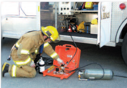
El MACK-2 es ideal para el recargado de emergencia de cilindros SCBA desde estaciones para comando de aire.
