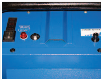
INTERRUPTOR DE VELOCIDAD VARIABLE Y PANEL DE CONTROL
