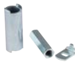
Modelo 01110142 Vástago de extensión de 2 1/4" / 5.7 cm para protección contra congelamiento de válvula de bola de 1/2" / 1.3 cm
