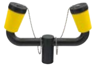
Modelo 01052111 Conjunto de lavajos; aspersores y "Y" en ABS, tapas en ABS con cadena tipo cordón de SS, entrada de 1/2" / 1.3 cm, 0.4 gpm / 1.5 lpm, para lavajos presurizados de auto-contenido
